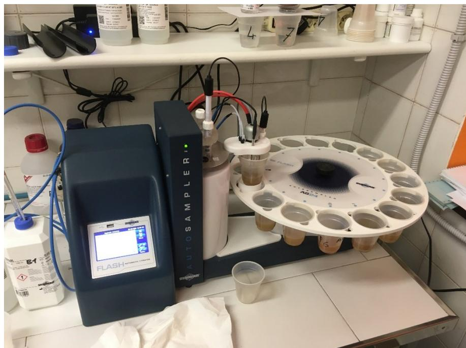
*Figura 2-4: Titolatore automatico "Steroglass" per la determinazione del pH e AT.*
