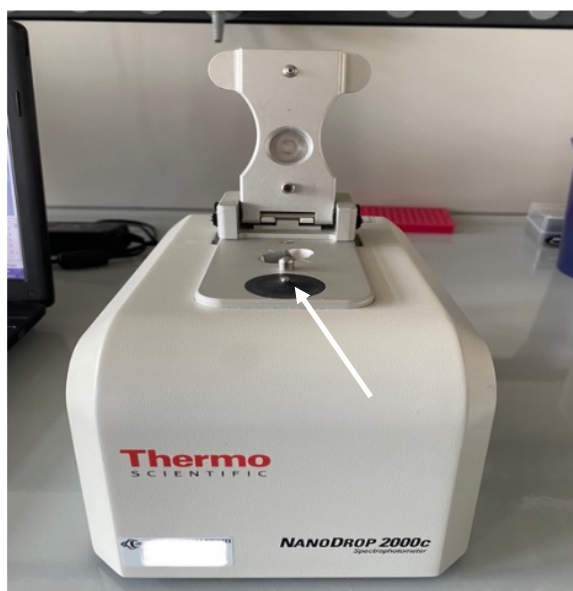
Figura 5. NanoDrop 2000C . Il piedistallo, indicato dalla freccia, rappresenta la parte dello strumento adibita al caricamento dei campioni da analizzare.
