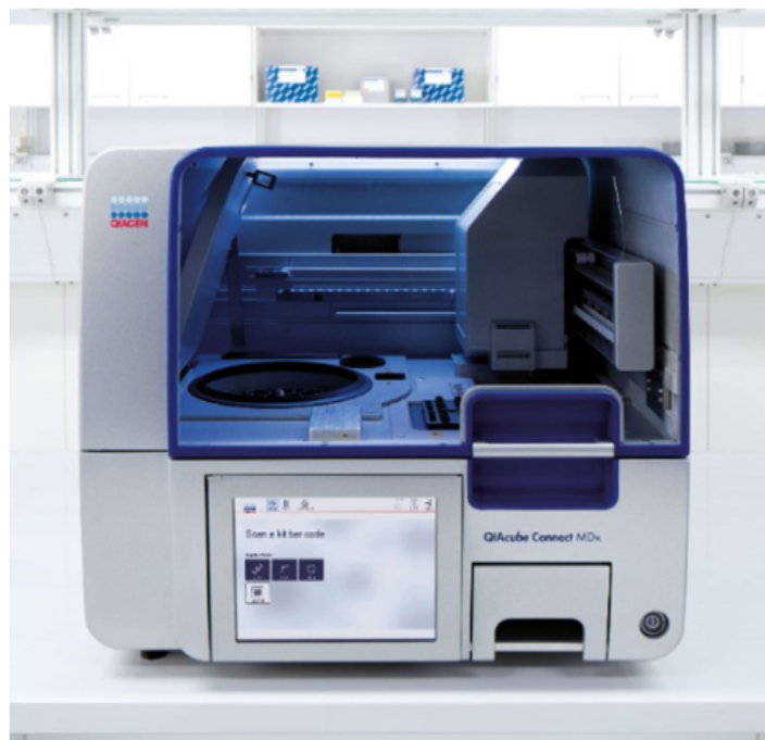
Figura 3. Rappresentazione dello strumento QIACube , utilizzato per l'estrazione automatizzata del DNA da campioni di sangue intero 50 .
