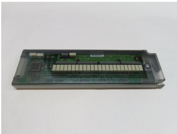
Figura 16: Modulo di acquisizione HP 34901A
