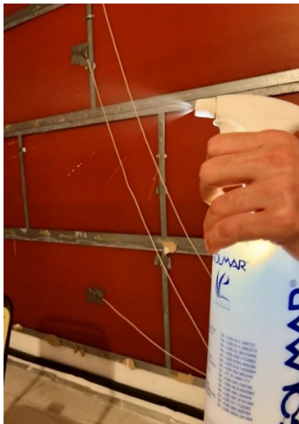
Figura 28: Foto della prima modalità di immissione di inquinante utilizzata (spruzzatore)
