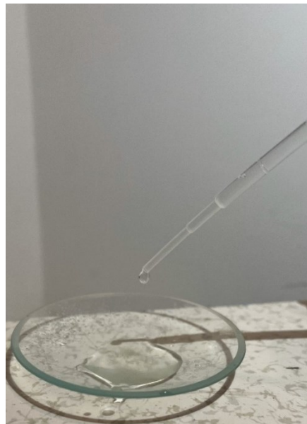
Figura 29: Foto della prima modalità di immissione di inquinante utilizzata (vetrino da orologio)
