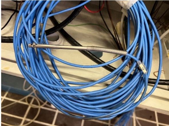
Figura 14: Termocoppia di tipo T utilizzata
