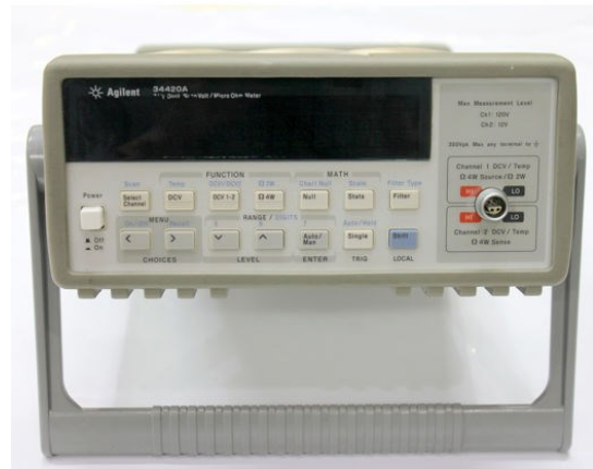
Figura 15: Agilent HP34420A, micro-ohmmetro a bassa resistenza
