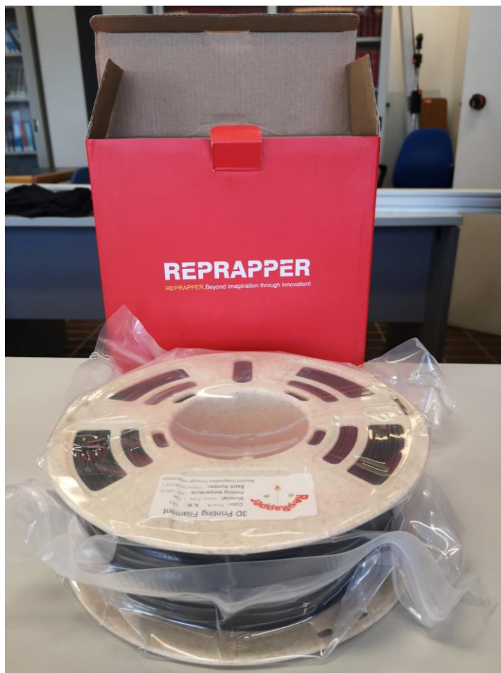
Figura [14] – Bobina di PLA con fibre di carbonio
