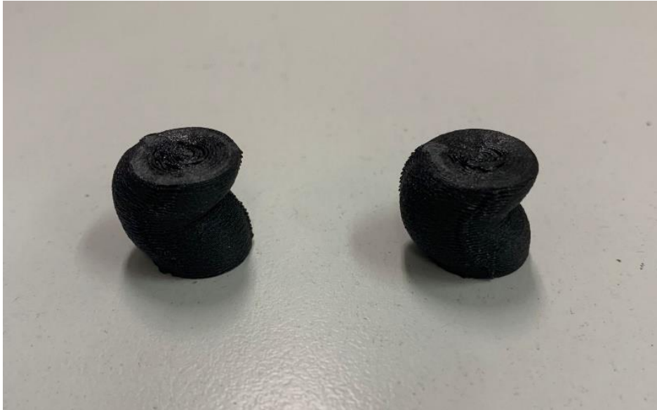
Figura [28] – Provini in CarbonFil™ dopo la prova di compressione
