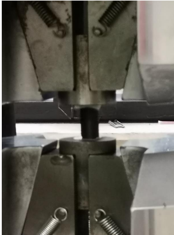
Figura [29] - Posizionamento del provino sulla macchina
