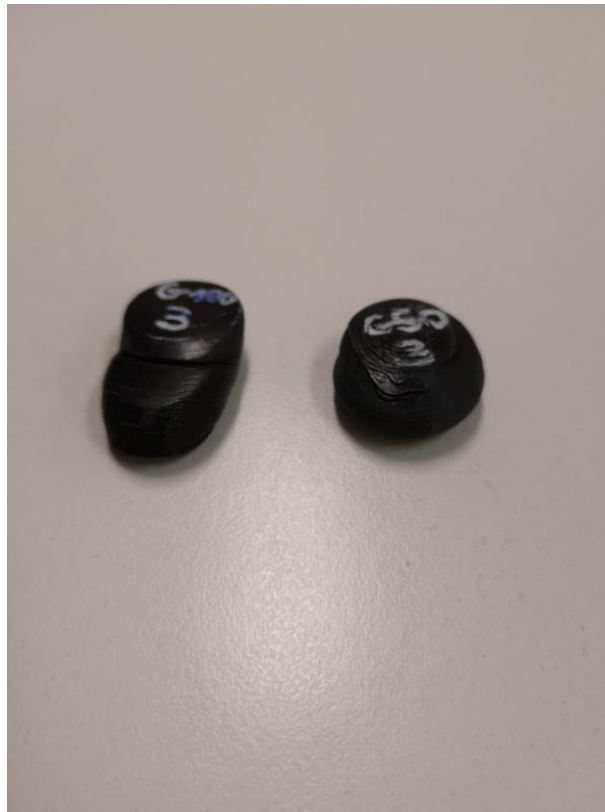
Figura [27] – Provini in PLA deformati dopo la prova di compressione
