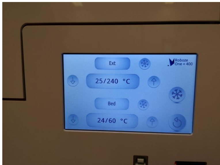
Figura [23] – Settaggio delle temperature tramite il display touchscreen
