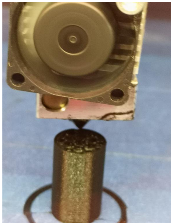
Figura [20] – Fase di stampa di un provino in PLA con infill di tipo honeycomb
