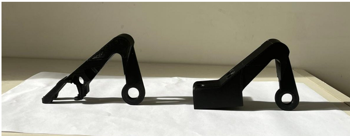
Figura 3.10 Confronto tra i due prototipi, a sinistra quello con la geometria ottimizzata mentre a destra quello con la geometria di partenza
