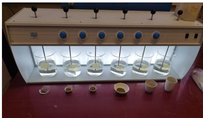
Figura 12- Prova Jar Test con campioni numerati e dosaggi crescenti di fango
