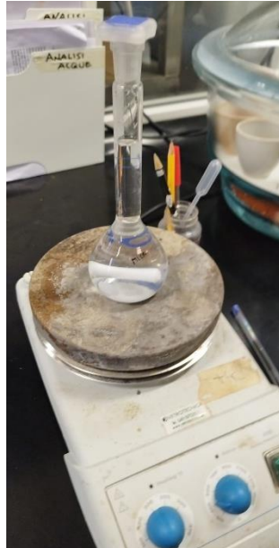
Figura 13- Immagine miscelazione del flocculante commerciale per mezzo della bilancia magnetica
