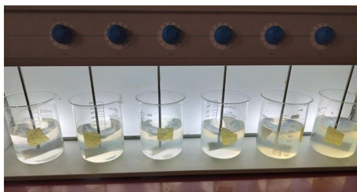
Figura 20- Jar Test, FlocculationTester durante la caratterizzazione con processo di acidificazione del fango
