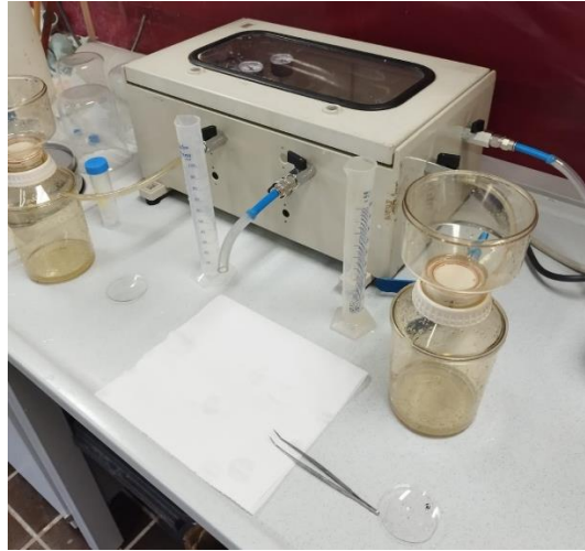
Figura 18- Sistema filtrante e macchina per indurre una pressione negativa
