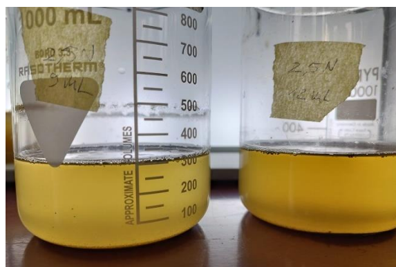
Figura 11- Esempio di separazione surnatante-solidi nella prova sul recupero di coagulante all'interno del D-WTS
