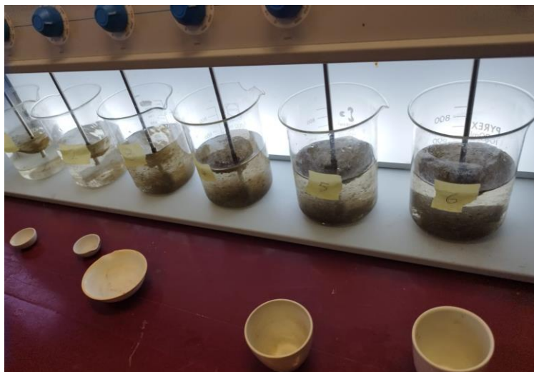
Figura 14- Immagine prova Jar Test con effluente unito al corrispondente dosaggio di fango essiccato
