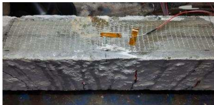
Figura 3.2 – Estensimetro incollato sulla striscia in GFRP
