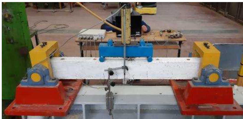
Figura 4.5 – Predisposizione strumenti e provino per la prova statica con danneggiamento – trave B1_D2
