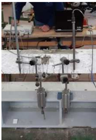
Figura 3.4 – Trasduttore di spostamento verticale in maniera simmetrica rispetto alla simmetria della trave
