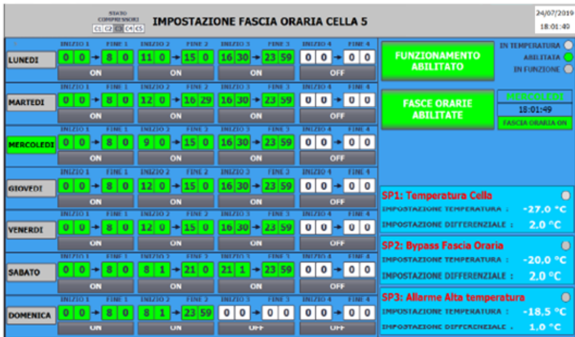
Figura 3-4: impostazioni fasce orarie di funzionamento.
