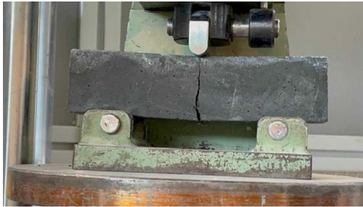
Setup di prova 4x4x16 cm 3
