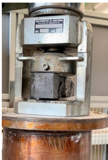
Setup di prova a compressione provini 4 \times 4 \times 16 \text{ cm}^3
