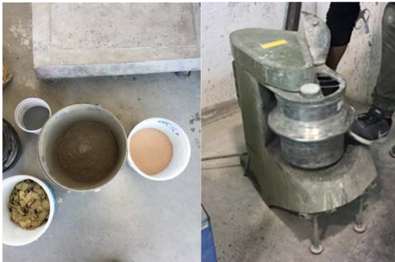
Pesatura componenti UHPC e successiva miscelazione
