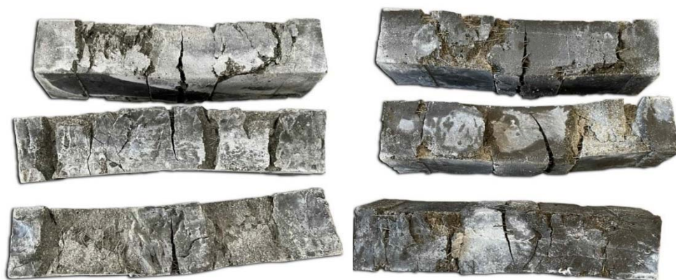
Rottura a compressione provini
