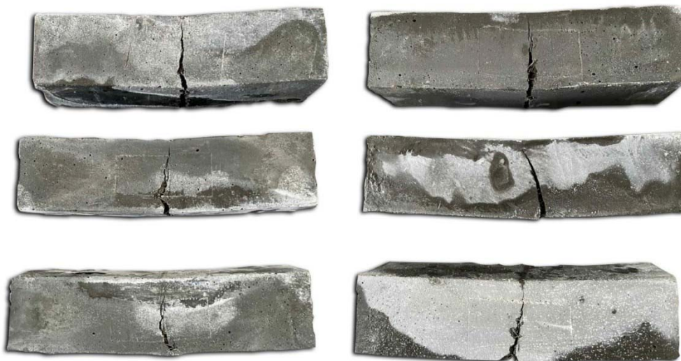
Rottura a flessione di tipo duttile provini
