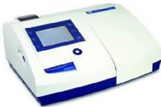
Fig. 18: Spettrofotometro JENWAY 6705 UV/vis, utilizzato per la valutazione dell'attività fosfatasica.
