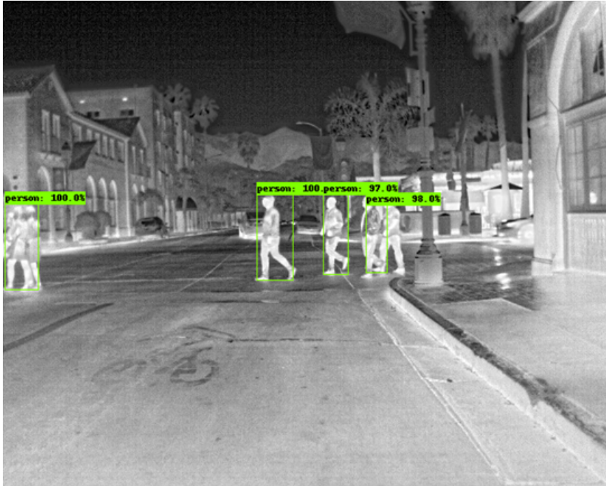
Figura 28: Applicazione della SSD-Mobilenet-v2 su di un'immagine di test (FLIR parziale). Solo la classe "persona" viene riconosciuta poichè è l'unica ad essere stata etichettata
