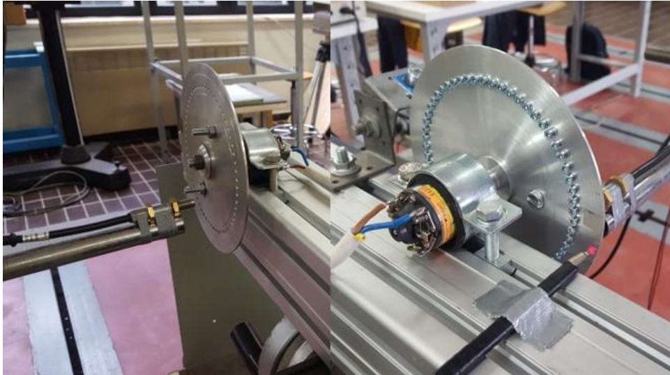
Figura 26. Particolare del sensore ad effetto Hall (sinistra) e del sensore ottico a destra
