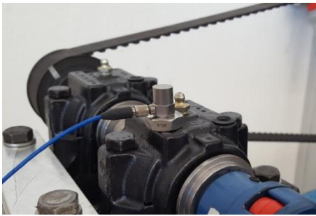
Figura 12. Accelerometro PCB C352C33 posto sul supporto ritto ad omega
