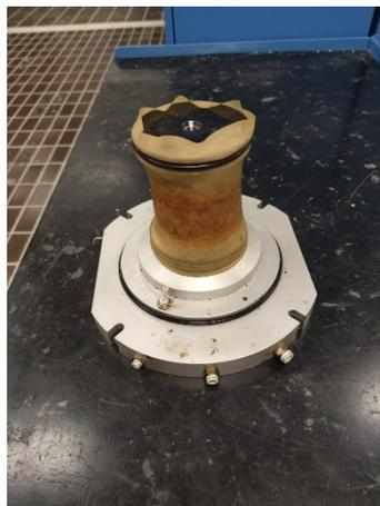
Figura 3.51 – Inserimento provino tra le due piastre di carico
