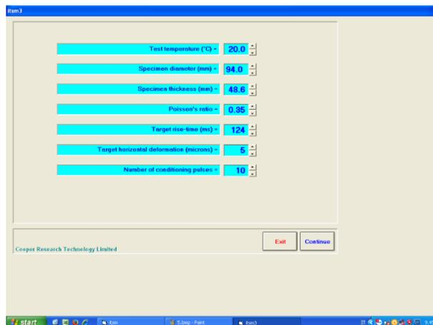
Figura 3.15 – Parametri per la prova ITSM
