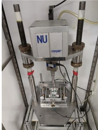
Figura 3.17 – Provino sotto il pistone di carico
