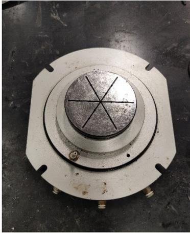
Figura 3.39 – Piastra di carico inferiore
