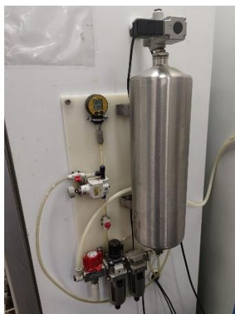
Figura 3.47 – Sistema pneumatico e manometro
