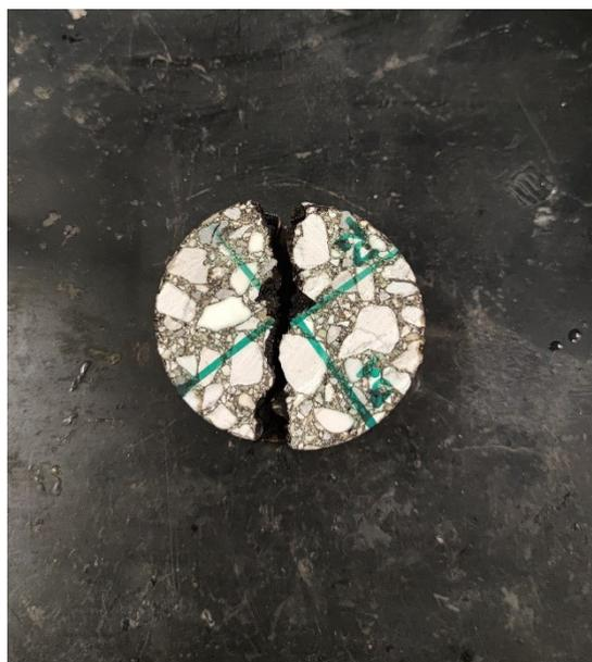
Figura 3.36 – Rottura del provino a fine prova
