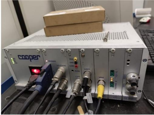
Figura 3.12 – Sistema di acquisizione data
