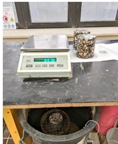
Figura 3.5 – Misura massa  $m_2$  (pesata idrostatica)
