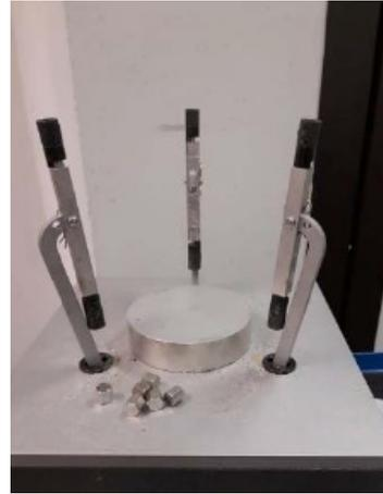
Figura 3.55 – Attrezzatura per l'incollaggio
