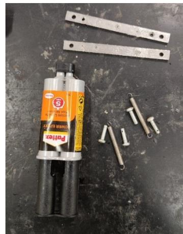
Figura 3.26 – Placchette e attrezzatura per l'incollaggio
