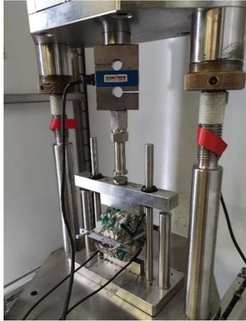
Figura 3.32 – Posizionamento del provino all'interno del NAT
