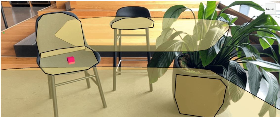
Figura 1.6: Tracciamento di piani (AR Foundation)
