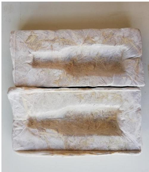
*Figura 2-1: Prototipo: parti dell'involucro con il calco formato dallo stampo in cui collocare la bottiglia (25,5 cm x 11,5 cm x 4,5 cm)*
