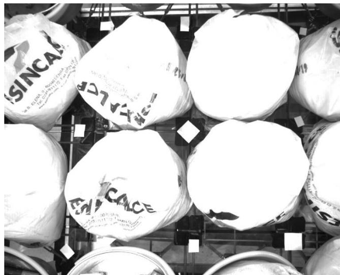
*Figura 4 - Piano carico uniformemente con 400 kg*
