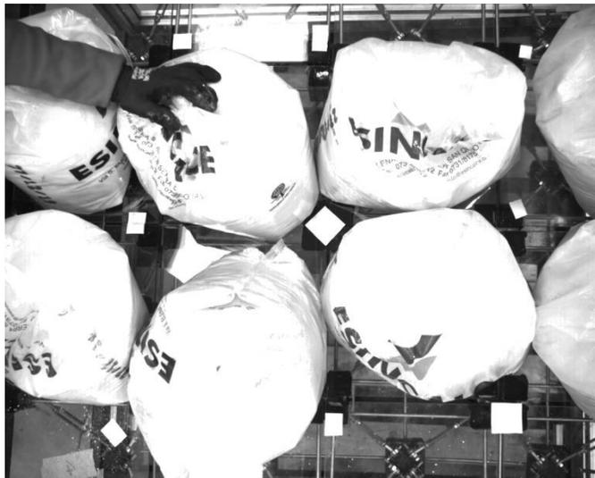
*Figura 2 - Piano carico con 200 kg centrali*
