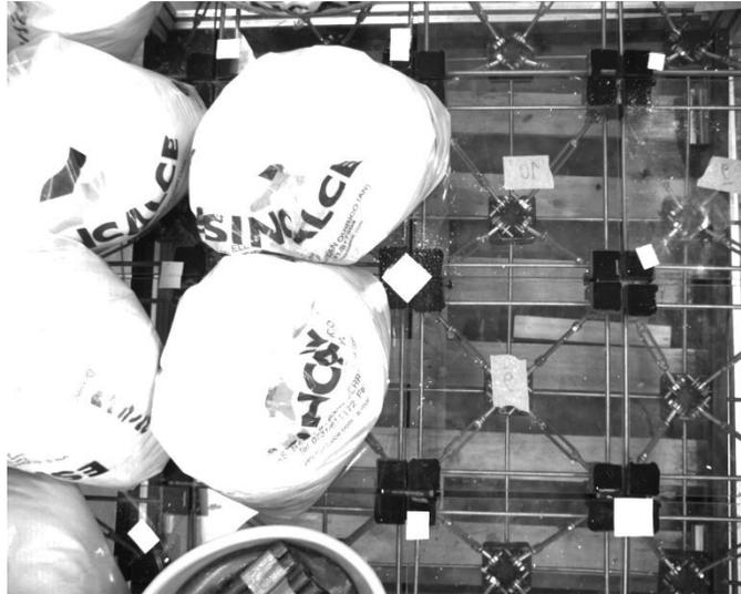
*Figura 3 - Piano carico con 200 kg laterali*
