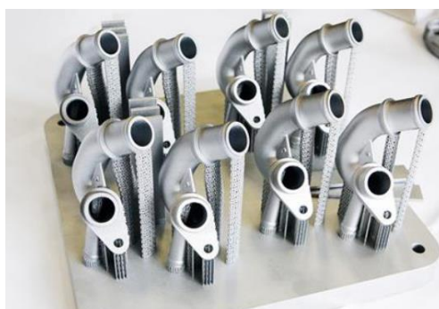
Figura 6-13 prodotti stampati con le relative strutture di supporto
