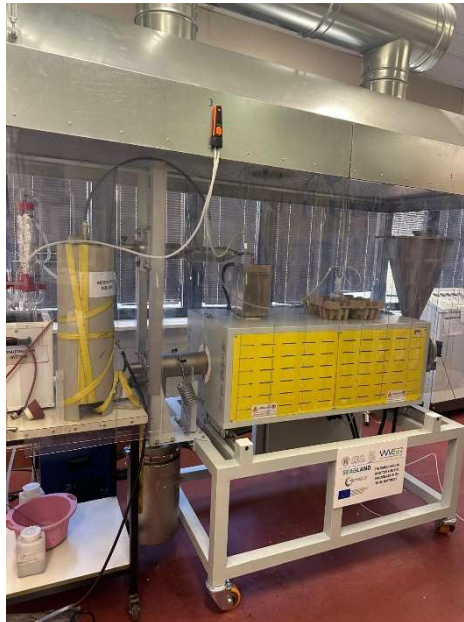
Fig 1. Pirolizzatore presente nel laboratorio
