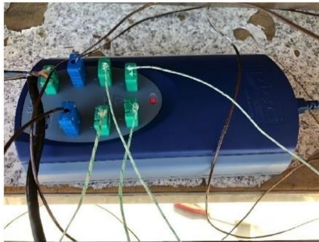
Fig 4.3 – Termocoppie collegate ad un acquisitore
