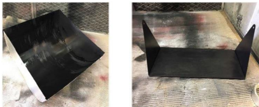
Fig. 2.7 – Verniciatura camera di cottura e piano inclinabile
