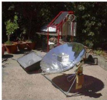
Fig. 1.9 – Forno solare parabolico con sistema integrato a pannelli fotovoltaici [10]
