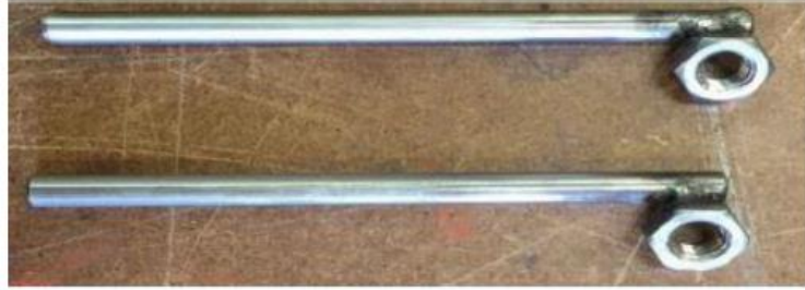
Fig. 3.12 – Tubo in acciaio inox saldato al dado
