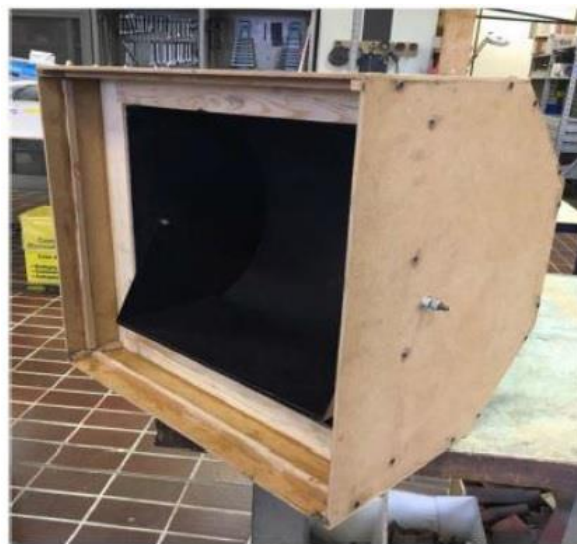
Fig. 2.12 – Inserimento camera di cottura nell'involucro esterno
