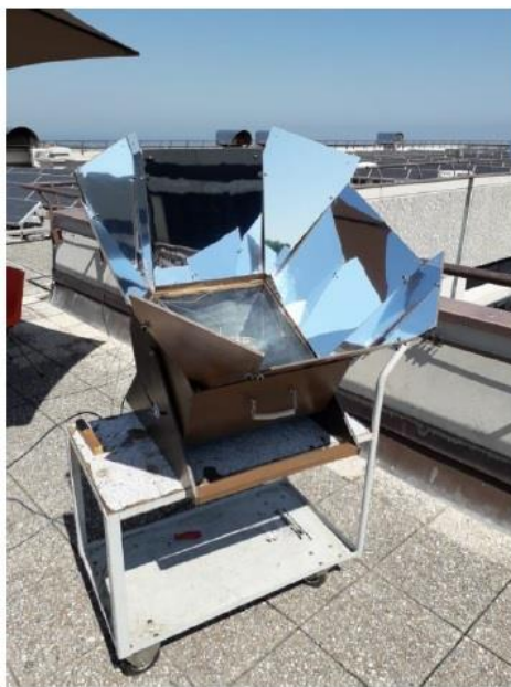
Fig. 2.1 – Forno solare a scatola portatile realizzato presso il DIISM
