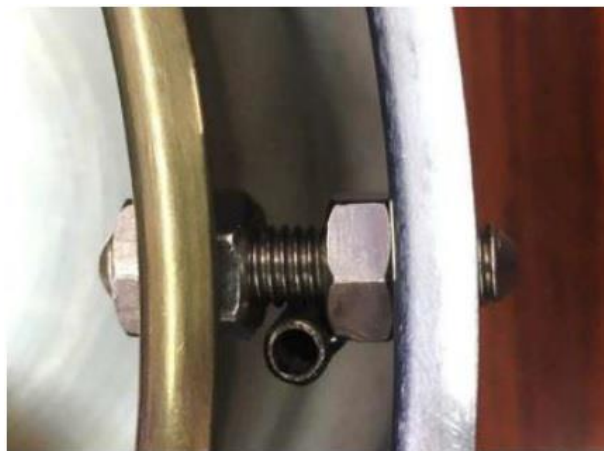
Fig. 3.11 – Sistema per fissaggio delle due pentole e posizionamento della termocoppia
