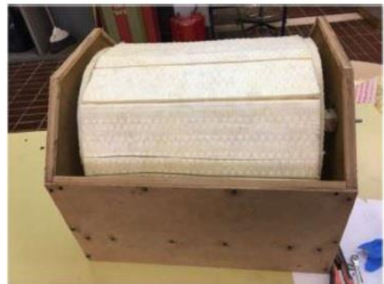
Fig. 2.14 – Riempimento fessure con materiale isolante
