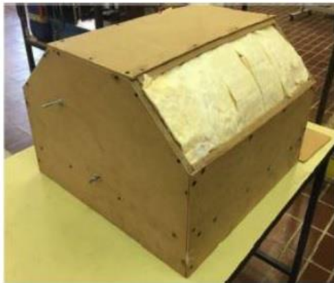
Fig. 2.14 – Riempimento fessure con materiale isolante
