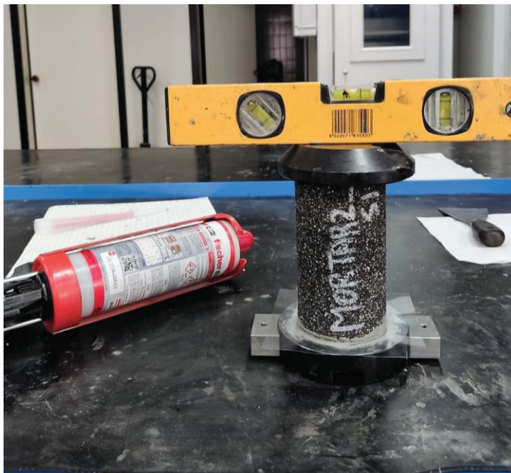
Figura 33. Livellamento delle facce del provino.
