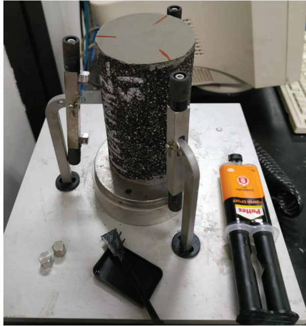
Figura 34. Provino sulla piattaforma di incollaggio.
