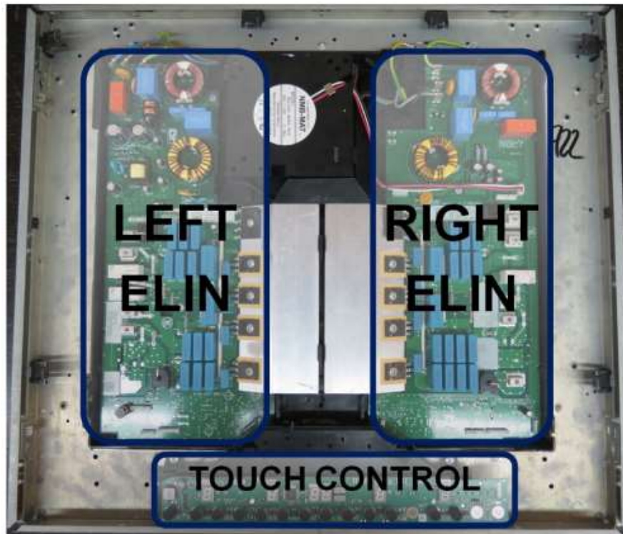
Figura 38: Immagine delle schede elettroniche con i loro componenti
