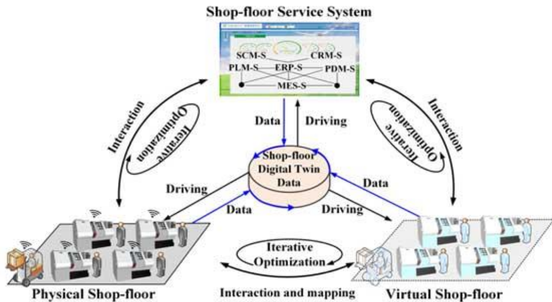
Figura 17: Modello di Digital Twin Shop-Floor (fonte [29])
