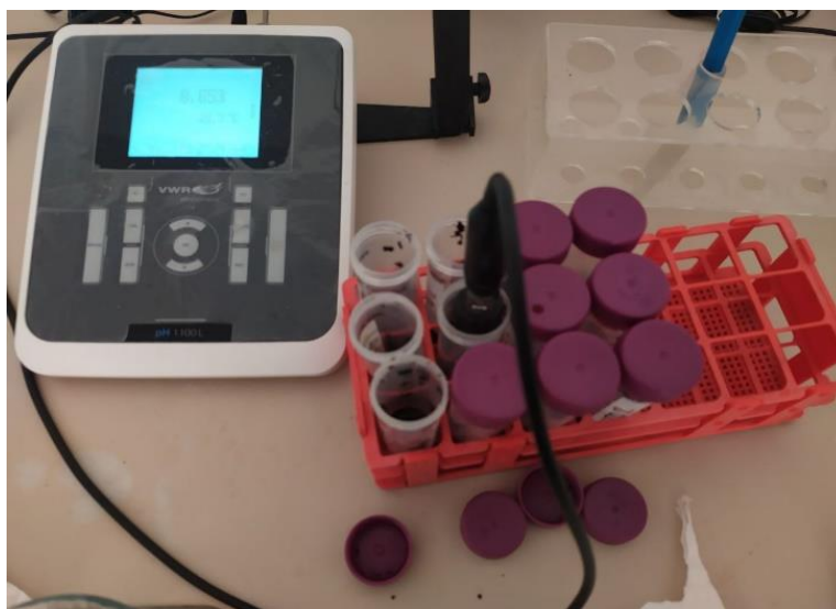
Figura 12 dettaglio del piaccametro e delle provette "Falcon"
