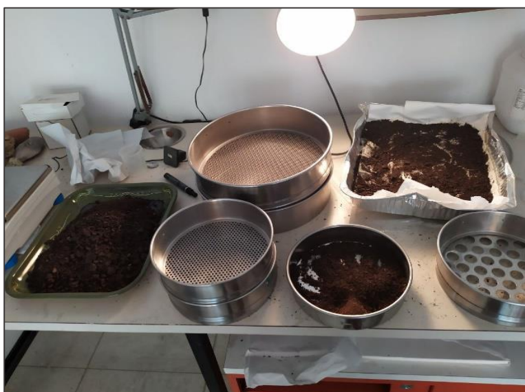
Figura 8: Dettaglio sui vagli utilizzati durante la ricerca meccanica degli elastomeri di diverso diametro
