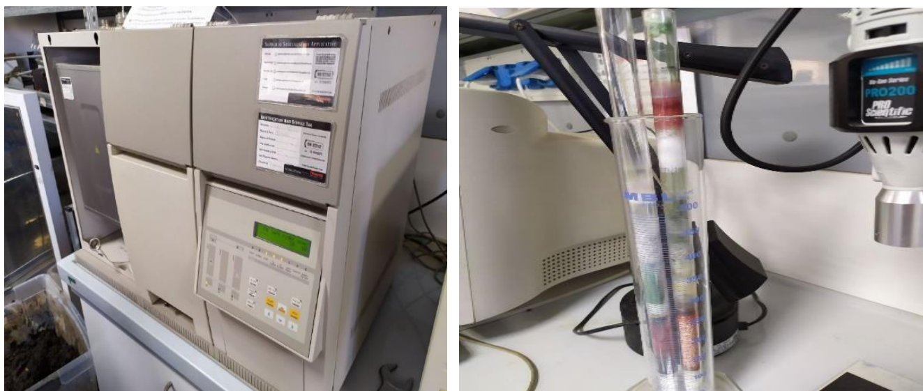
Figura 14: A sinistra l'analizzatore elementare carlo erba mentre a destra esempio di colonne al quarzo.
