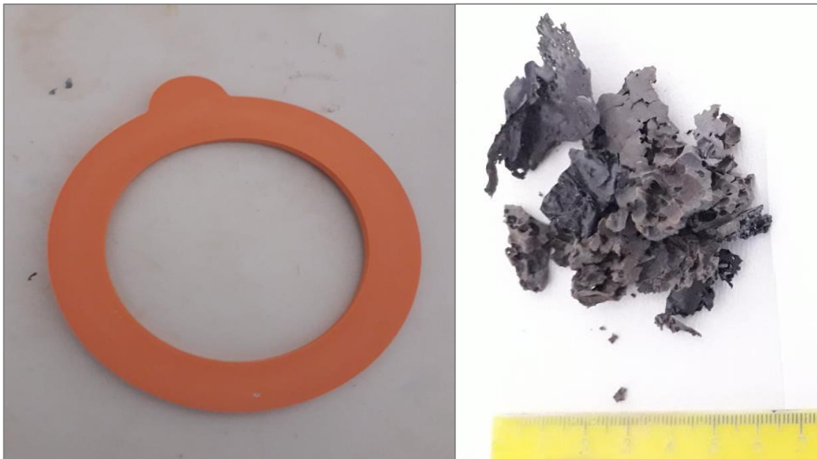
Figura 5: dettaglio sugli elastomeri siliconici e sperimentali
