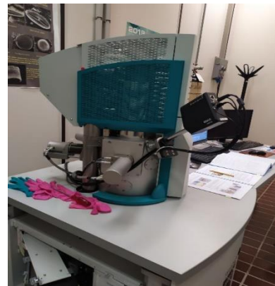
Figura 11.2: Dettaglio su dispositivo S.E.M. con sonda E.D.X, rappresentata dalla scatola nera collegata.
