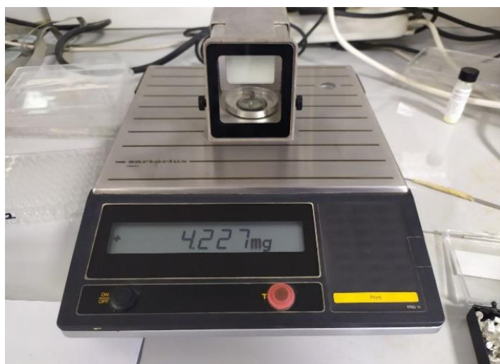
Figura 13: Dettaglio della bilancia a 6 cifre decimali
