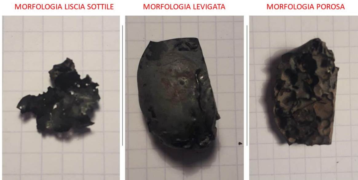
Figura 9: Dettaglio sulla classificazione in base alla loro morfologia degli elastomeri sperimentali
