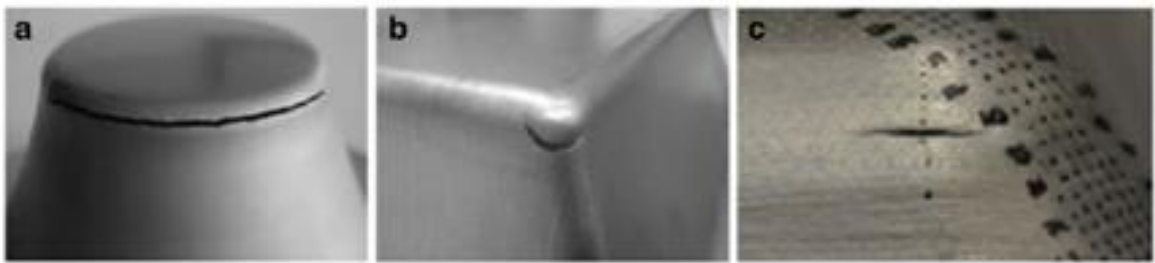
Figura 4.3: Crepa circonferenziale in deformazione piana, condizioni di simmetria rotazionale che può anche propagarsi a zig-zag; b Crepa in stiramento biassiale, condizioni di simmetria rotazionale; c Inizio della crepa dopo la strizione sotto stiramento biassiale, condizioni di simmetria rotazionale dovute all'uso di un utensile di grandi dimensioni (ad es. diametro dell'utensile > 20 mm).
