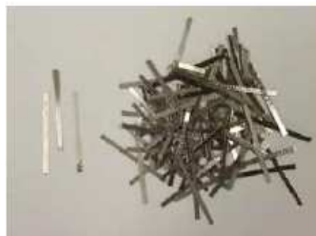
Figura 4.24 –Fibre di carbonio inserite nell'intonaco Armamuro
