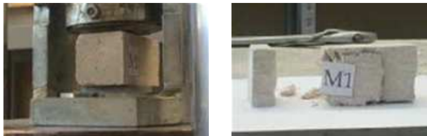
Figura 4.22 – Esempio di come si è svolta la prova di compressione sui provini dopo la prova di flessione, provino M1.
