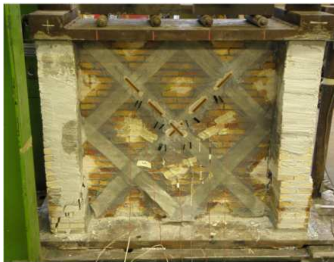
Figura 4.4 – Distaccamento delle strisce in basso nel provino R-W2
