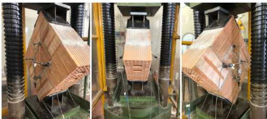
Figura 4.16 – Configurazione di prova per laterizio POROTON.
