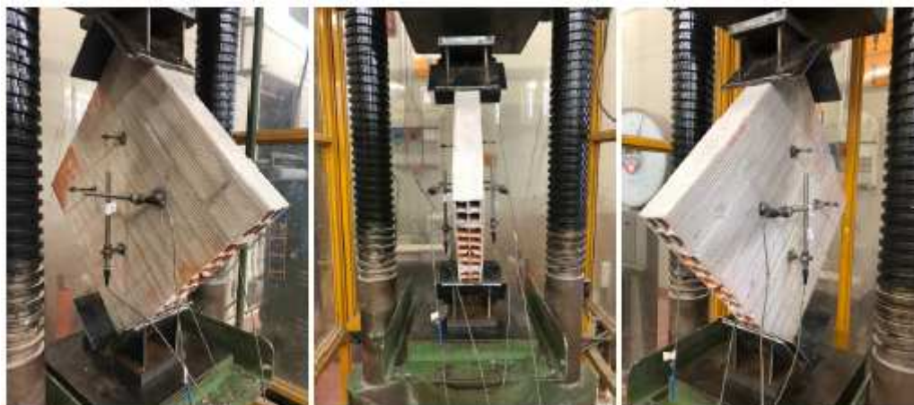
Figura 4.13 – Configurazione della prova con forato 25x25x8 cm.
