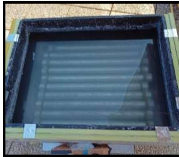
Figura 10. Solar pond con PCM
