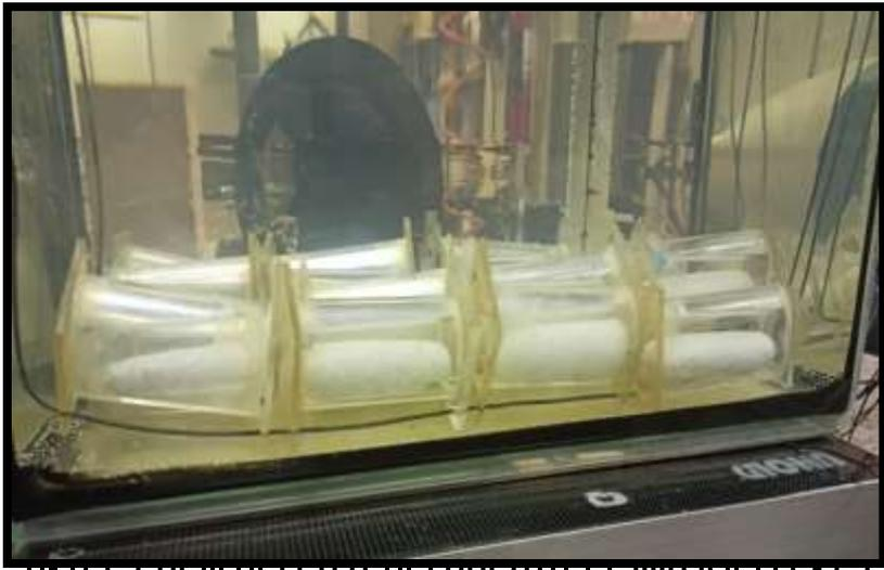
Figura 3. Tubi di PCM nel solar pond indoor
