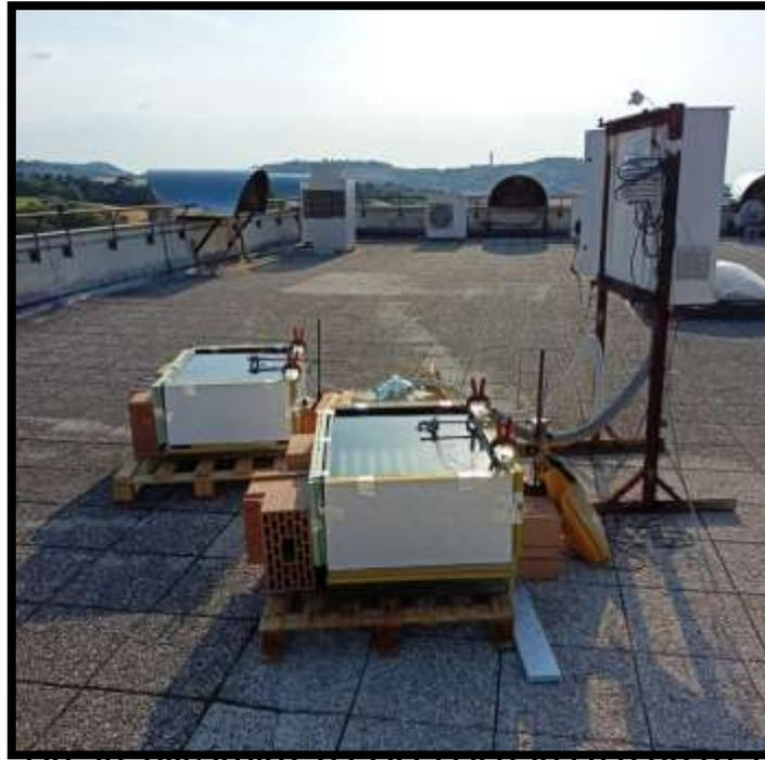
Figura 13. Solar pond analizzato
