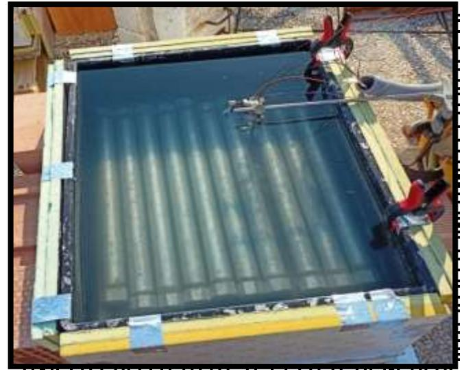
Figura 4. Tubi di PCM nel solar pond outdoor
