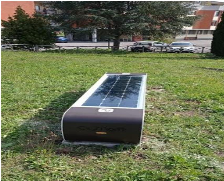
*Figura 19 -" Panchina smart" funge da panchina e ricarica batteria per cellulari e computer. funziona interamente ad energia solare (disponibile presso: <http://www.comune.castelnuovodiporto.rm.it/panchine-intelligenti-con-wi-fi-e-ricarica-usb-al-via-linstallazione-nei-parchi-pubblici-e-presso-le-fermate-del-cotral/panchine-smart/>)*
