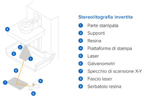
Figura 1.3 Rappresentazione grafica della meccanica di funzionamento della SLA
