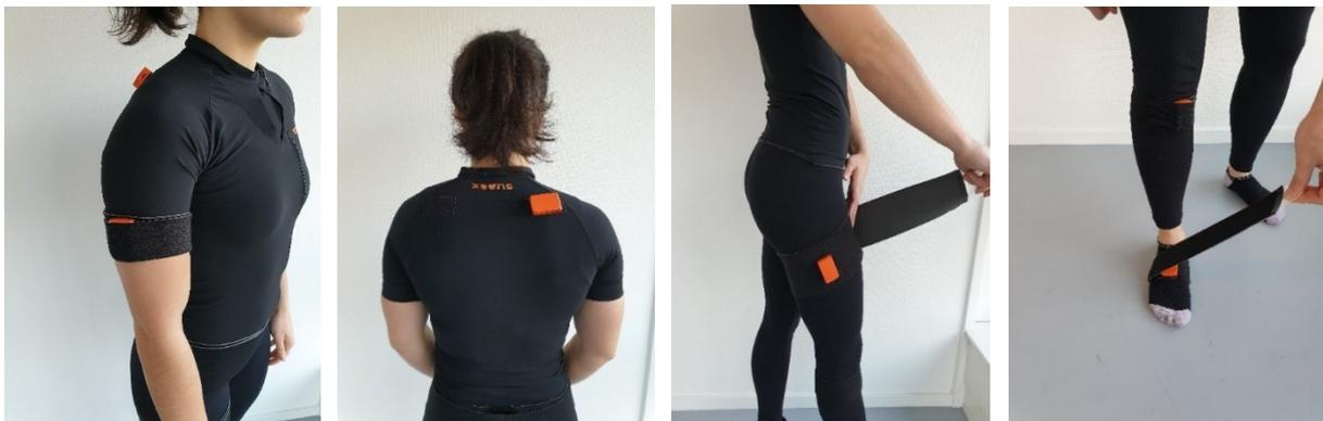
Figura 3.5 Applicazione dei sensori inerziali Xsens solidalmente ai segmenti anatomici (avanbraccio, spalla, coscia, piede). [23]
