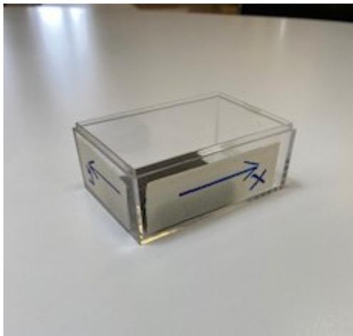
Figura 3.1 Cassa di plastica trasparente usata per effettuare la calibrazione.
