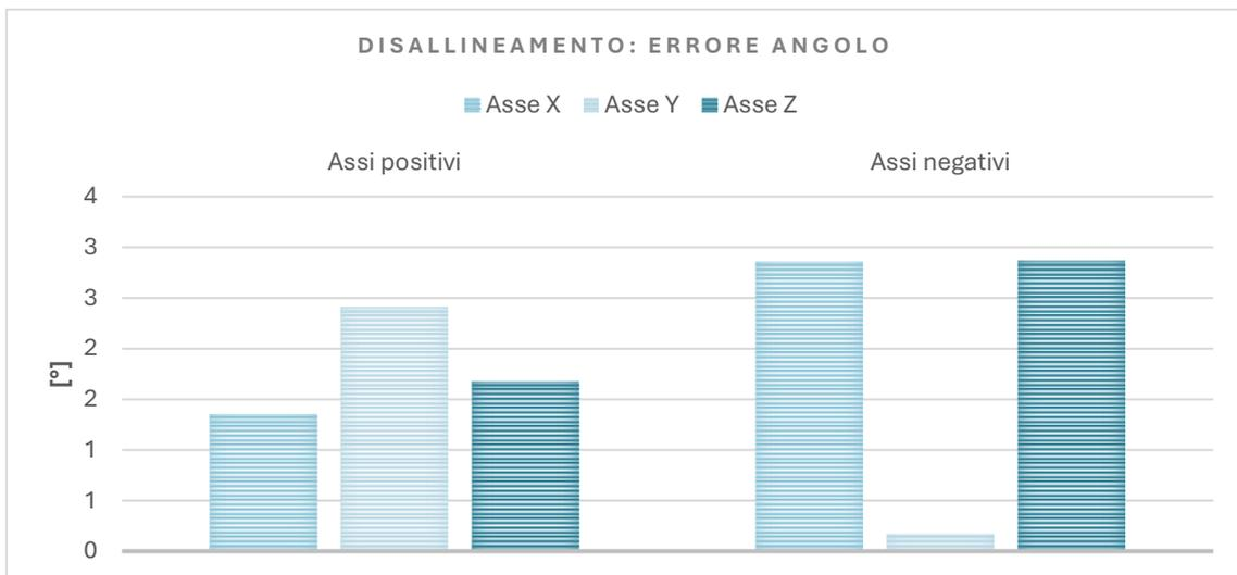
Figura 4.6 Disallineamento degli assi calcolato in termini di angolo compreso; i due gruppi costituiscono rispettivamente l'allineamento degli assi parallelamente alla direzione di g (considerata verso l'alto) e in modo antiparallelo, le tre colonne sono i tre assi.
