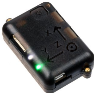
Figura 4.1 Sensore NGIMU utilizzato per effettuare le misurazioni su pazienti affetti da malattia di Parkinson [32].
