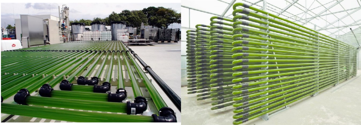
Figura 6. Esempio di fotobioreattore tubulare, tipologia orizzontale e verticale.
