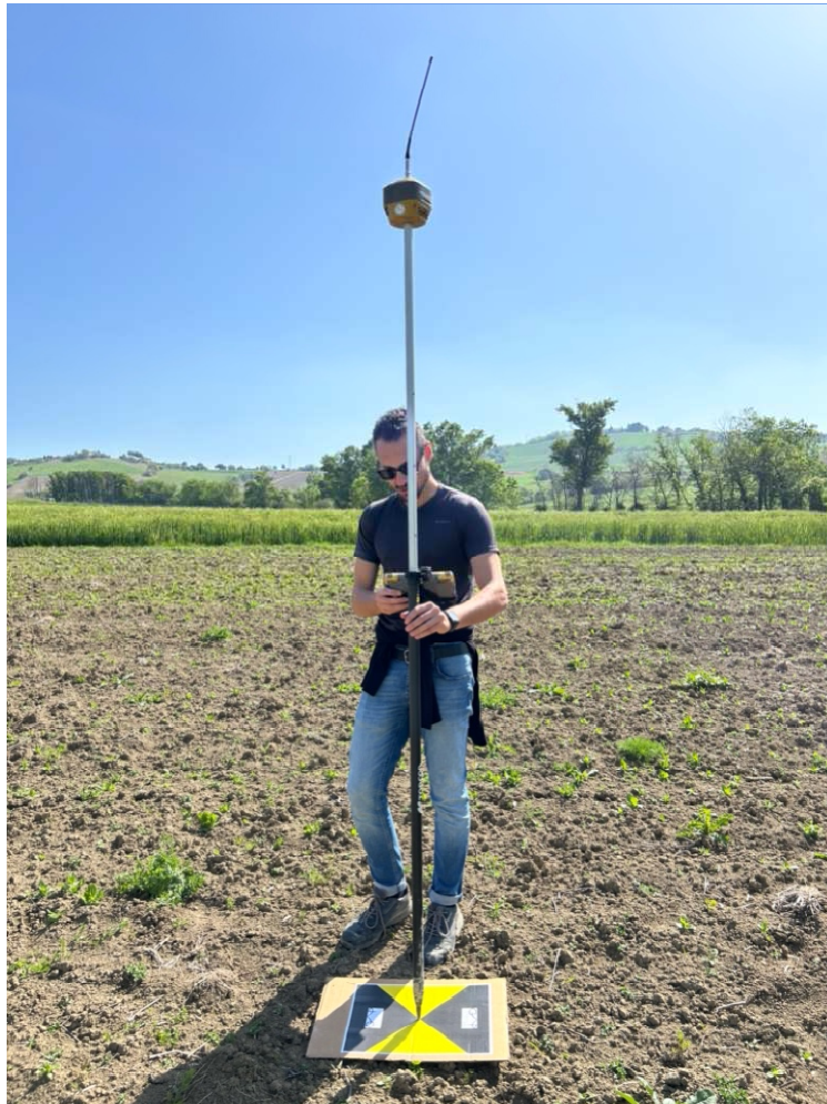
Figura 13: Piazzamento dei target topografici
