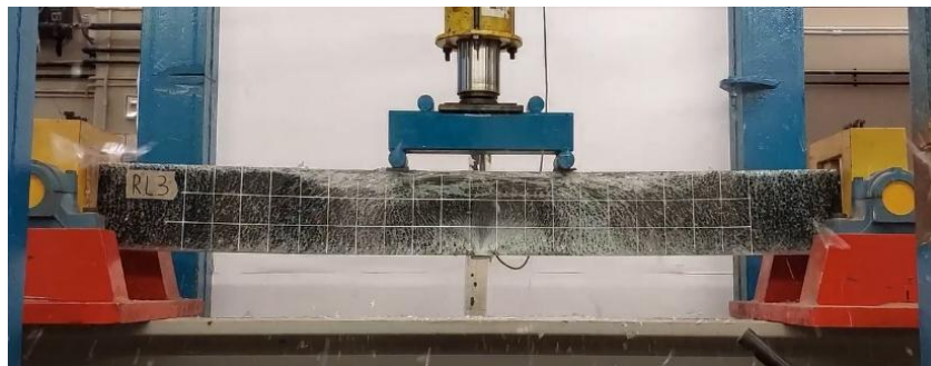
Fig. 4.14 Rottura del provino RL3.
