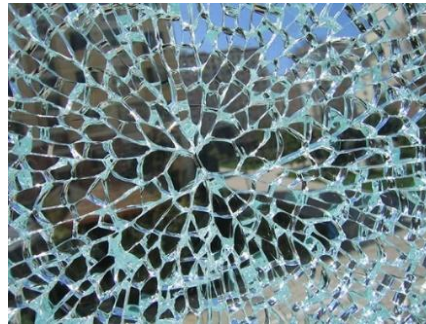
Fig. 1.16 Tipica rottura “a farfalla” derivante da inclusioni di Solfuro Di Nichel. Fonte: [u].
