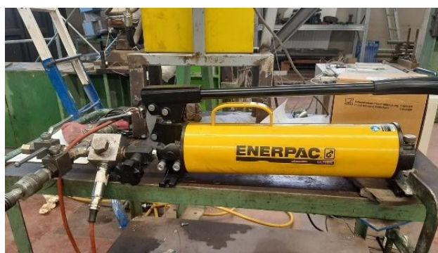
Fig. 4.9 Pompa idraulica ENERPAC (500 bar) utilizzata nella prova.
