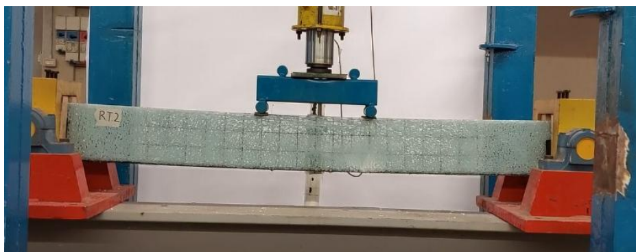
Fig. 4.16 Rottura del provino RT2.
