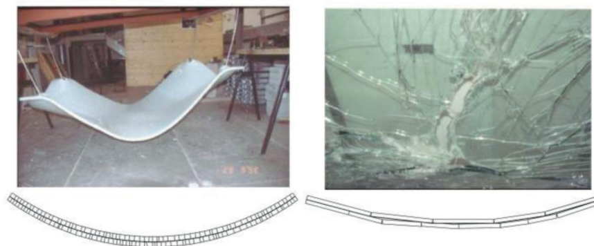
Fig. 2.3 Deformazione post-rottura (in termini di freccia) del vetro stratificato con lastre temperate (a sinistra) e con lastre di vetro indurito (a destra).
