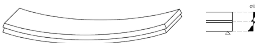
Fig. 2.11 Distribuzione delle tensioni nella situazione reale.
