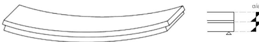
Fig. 2.10 Distribuzione delle tensioni nel caso “a strati indipendenti”;
