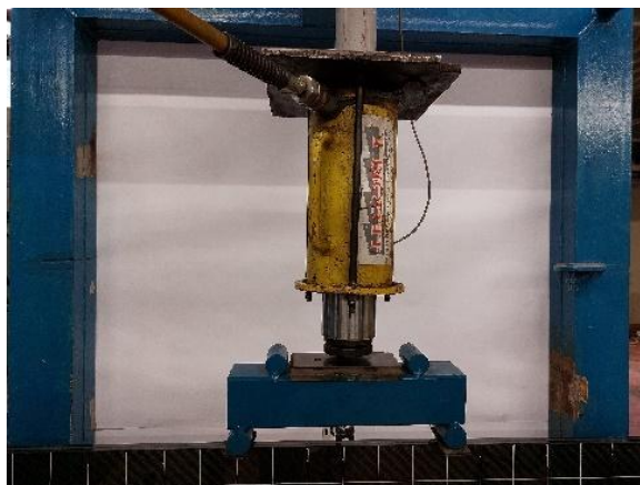
Fig. 4.8 Martinetto idraulico ENERPAC (capacità di 50 tonnellate) utilizzato nella prova.
