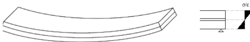
Fig. 2.9 Distribuzione delle tensioni nel caso “monolitico”;
