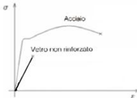
Fig. 2.5 Confronto qualitativo dei legami costitutivi di vetro e acciaio (fuori scala). Fonte: [5], [12].
