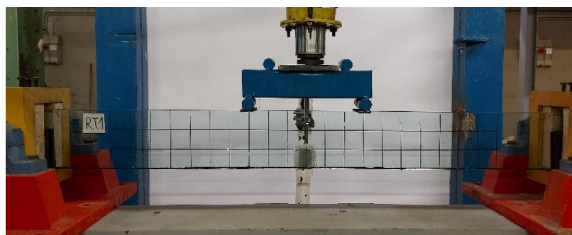
Fig. 4.3 Provino in vetro stratificato rinforzato con tessuto C-FRP, indicato per semplicità con la sigla “RT”.
