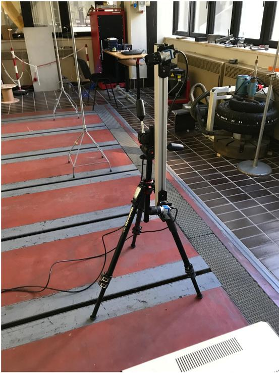
Le telecamere sono posizionate su un treppiedi e fissate su una rotaia dove possono traslare. Poiché la piastra si sviluppa in verticale la rotaia è stata ruotata anch'essa verticalmente. Le telecamere sono state inclinate in modo da avere un angolo di convergenza di circa  $30^\circ$ . Il treppiedi deve essere posizionato rigidamente in modo da minimizzare fonti esterne di vibrazione. Le telecamere sono state poste a circa 2 metri di distanza dal target.
