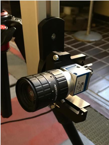
sinistra inquadrino lo stesso punto del target (la camera 0 è quella superiore, mentre la 1 quella posizionata inferiormente). Piccole differenze di altezza delle linee epipolari possono rendere difficile la calibrazione del sistema [7]. Per agevolare il posizionamento si può utilizzare lo speckle della griglia di calibrazione come punto di riferimento. Si procede con la messa a fuoco delle telecamere tramite l'obiettivo utilizzando sia una macroregolazione che una microregolazione dello stesso.
