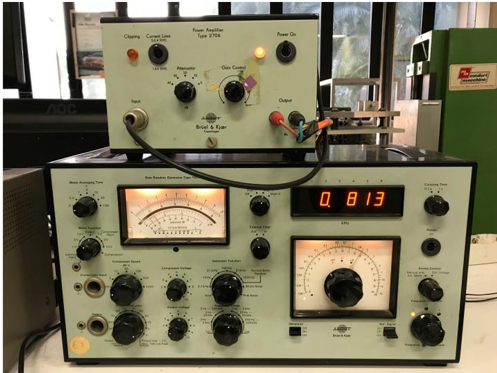
Nel setup di misura illustrato, lo shaker che trasmette la forzante alla piastra è alimentato da un generatore di segnale (Sine Random Generator Type 1027, Brüel & Kjær, Copenhagen) che è collegato all'amplificatore (Power Amplifier Type 2706, Brüel & Kjær, Copenhagen).
