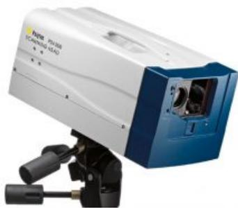
Il sistema di misura LDV è un trasduttore laser per misure senza contatto basato sul principio dell'effetto Doppler. Esistono due tipi di vibrometro laser: a singolo punto e full-field. Gli ultimi possono analizzare il comportamento dinamico di intere superfici e calcolare le ODS e i modi propri delle strutture testate.
