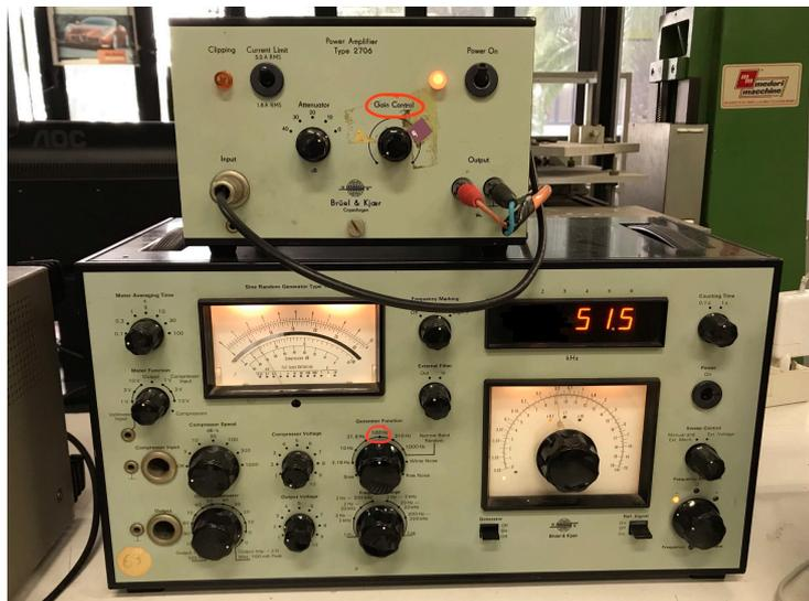
Figura 4.27 Generatore di segnale settato per Test-0-100
