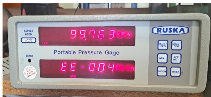
**Figura 20: Manometro digitale a cilindro vibrante**
