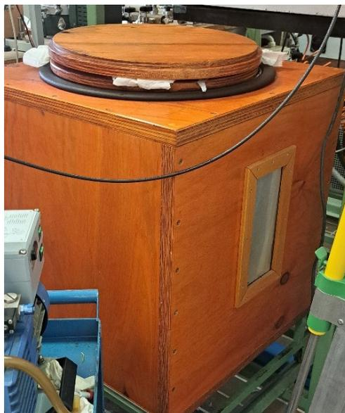
**Figura 23: Bagno termostatico**
