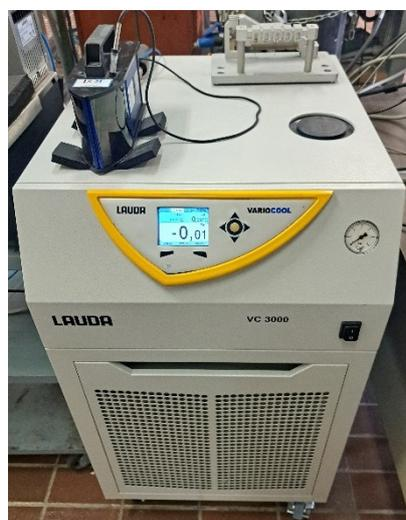
**Figura 21: Bagno termostatico ausiliario**
