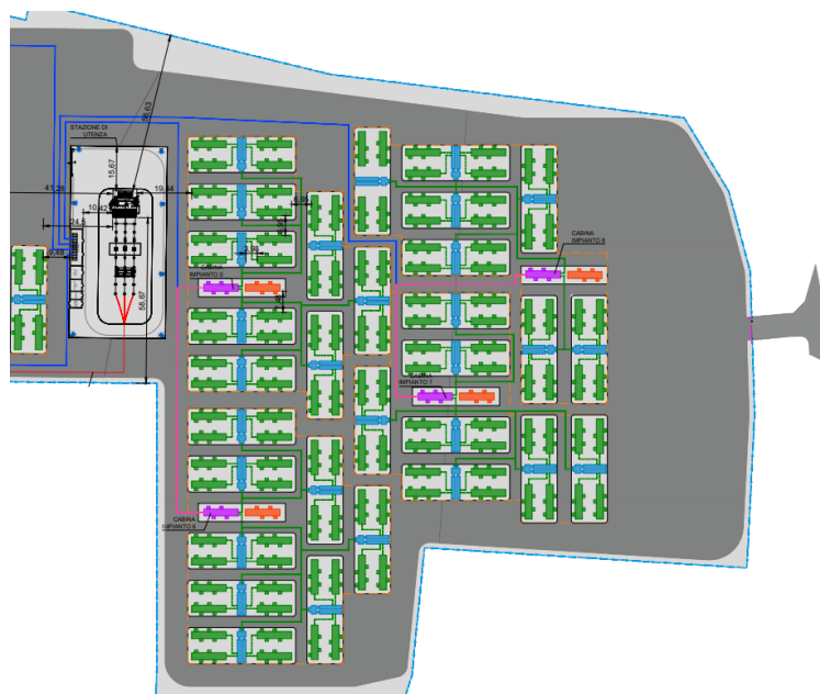
Figura 60 - Porzione del sistema BESS con i cavidotti interrati in MT (rosa e blu)
