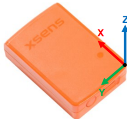
Figura 3.4: Sistema di riferimento del sensore [8]
