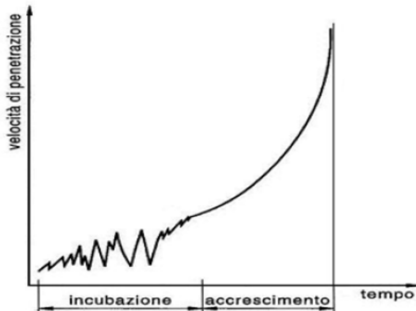
Fig. 2.3: velocità di accrescimento del pit in funzione del tempo.
