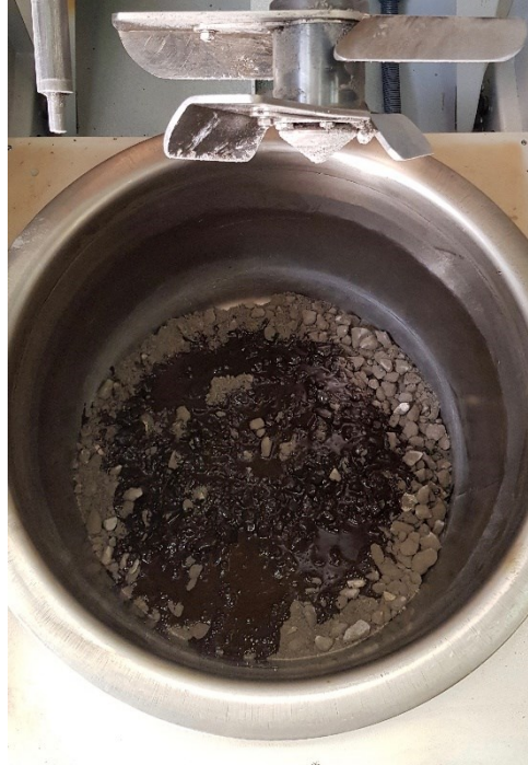
Figura 3.19 – Aggiunta dell'emulsione bituminosa nel miscelatore
