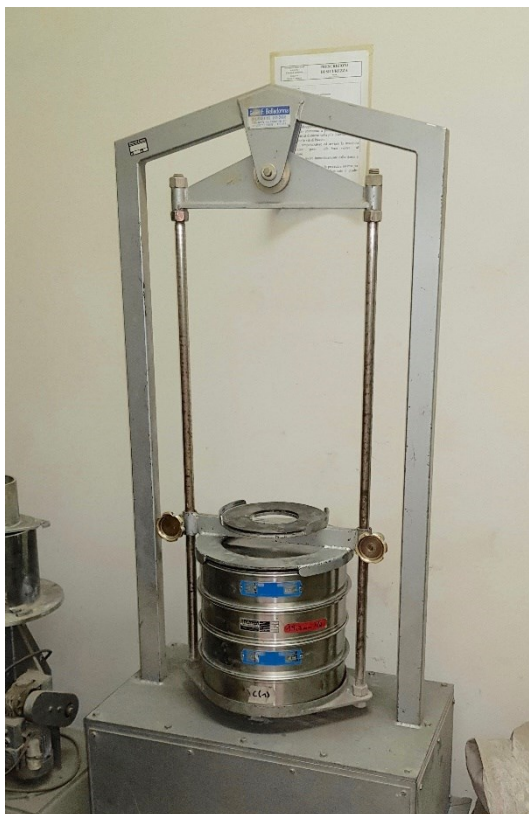
Figura 3.2 - Pila di setacci impiegata per ottenere il Fresato C posizionata nel vibro-vaglio
