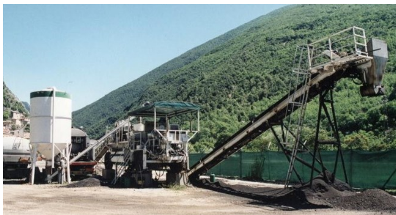
Figura 1.4 - Impianto fisso per la produzione di conglomerato bituminoso riciclato a freddo
