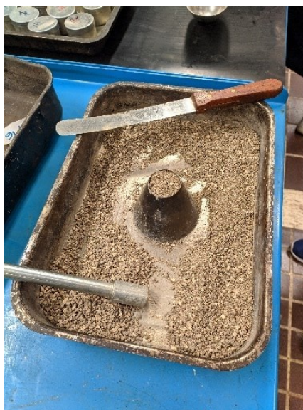
Figura 3.10 – Aggregati posizionati all'interno del cono
