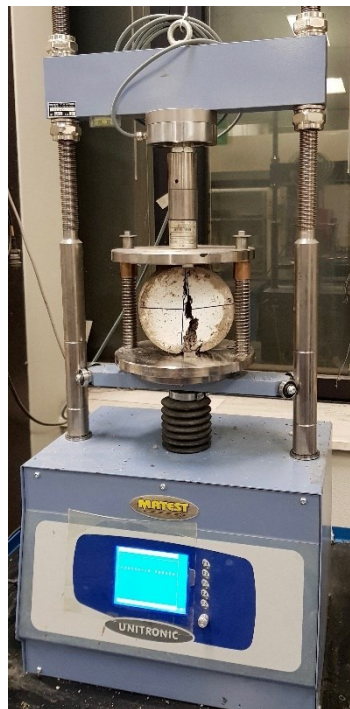
Figura 3.49 - Provino rotto con la prova di trazione indiretta
