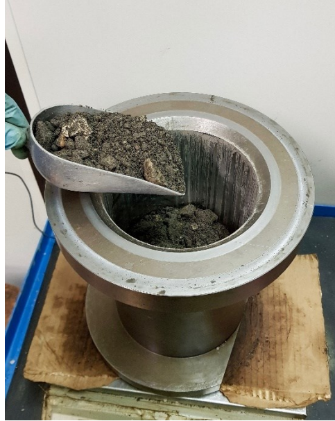
Figura 3.26 – Conglomerato bituminoso introdotto nella fustella
