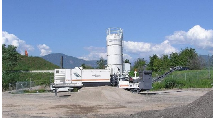
Figura 1.5 - Impianto mobile per la produzione di conglomerato bituminoso riciclato a freddo
