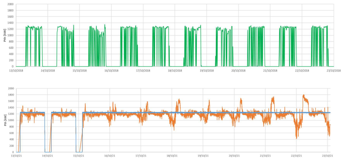
Figura 6.30 Confronto tra le potenze termiche del CHP nel 2018 (in alto) e nel 2021 (in basso)
