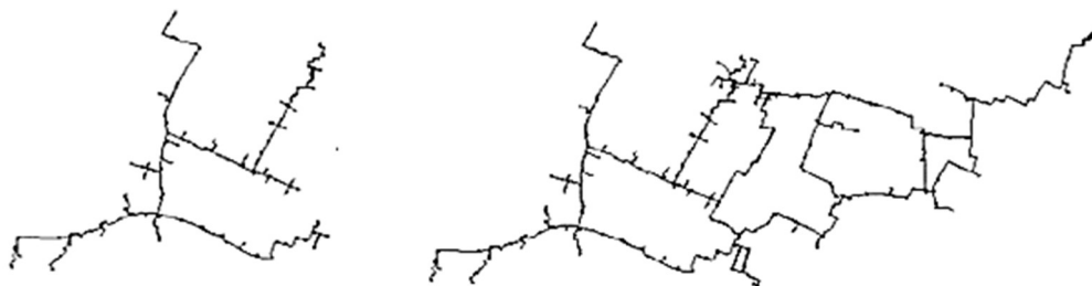
Figura 3.5 Esempio di una rete ad albero (a sinistra) e a maglie (a destra) [25]
