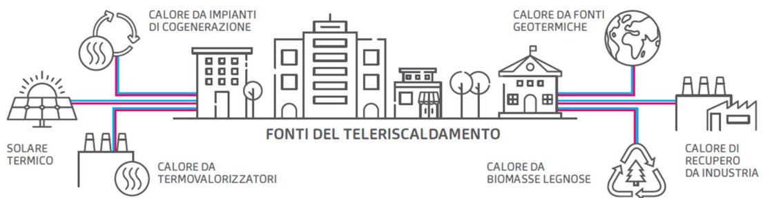
Figura 3.2 Sorgenti di calore utilizzato per il teleriscaldamento [15]
