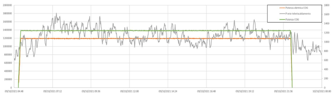
Figura 6.26 Andamento delle potenze termiche ed elettriche (CHP) in relazione alla potenza termica richiesta dagli utenti
