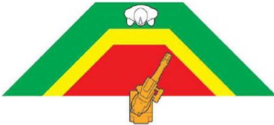
Figura 1.5: : aree di lavoro del robot, monitorate mediante laser o sistemi di visione in grado di tracciare la posizione dei lavoratori.
