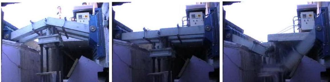
**Figura 2.35** Sistema di spinta durante le fasi di carico e di rilascio
