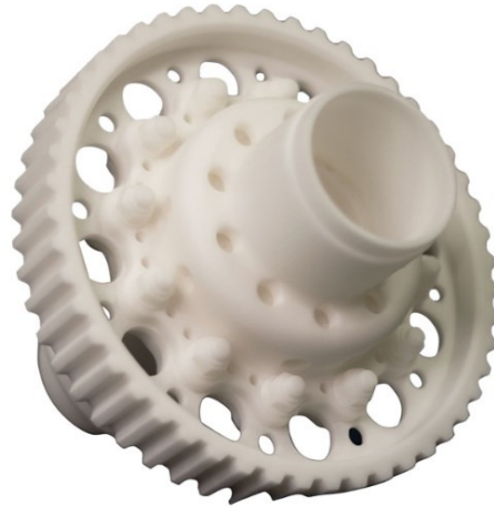
Figura 6. Componente realizzato in SLS
