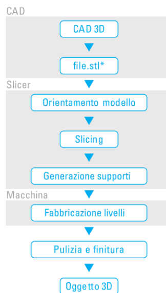
Figura 1. Fasi del processo di AM
