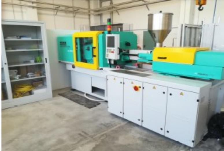
**Figura 8:** Macchina per lo stampaggio ad iniezione, equipaggiata con una vite da 30 mm e una forza di serraggio dello stampo di 60 ton.
