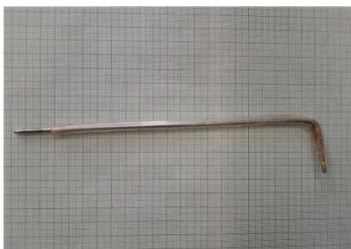
Figura 2.7: Asta in acciaio inossidabile per il collegamento elettrico.
