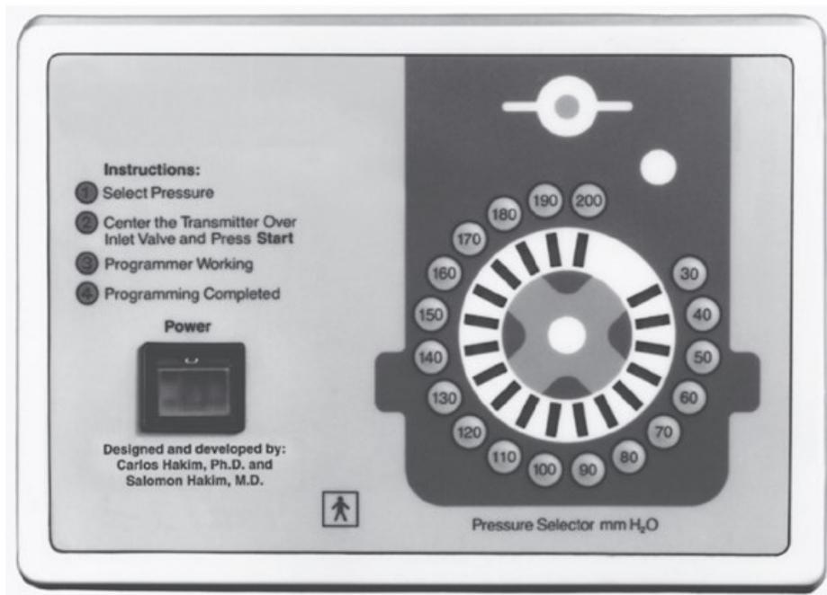
Figura 25 Unità di programmazione DVE Codman
