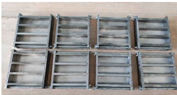
Fig. 12 – Casseri in metallo 16 \times 4 \times 4 \text{ cm}^3 con disarmante per provini di malta commerciale.
