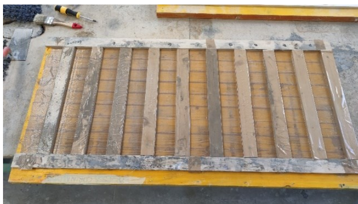
Fig. 14 – Casseri in legno 38 x 6 x 1 cm 3 con scotch per provini in composito con malta geopolimerica
