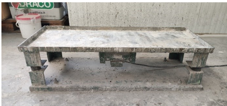
Fig. 27– Tavola vibrante usata nella sperimentazione.
