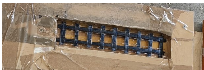
Fig. 17 – Rete in basalto per provini 19 \times 4 \times 1 \text{ cm}^3 con termocoppia (2 yarn).
