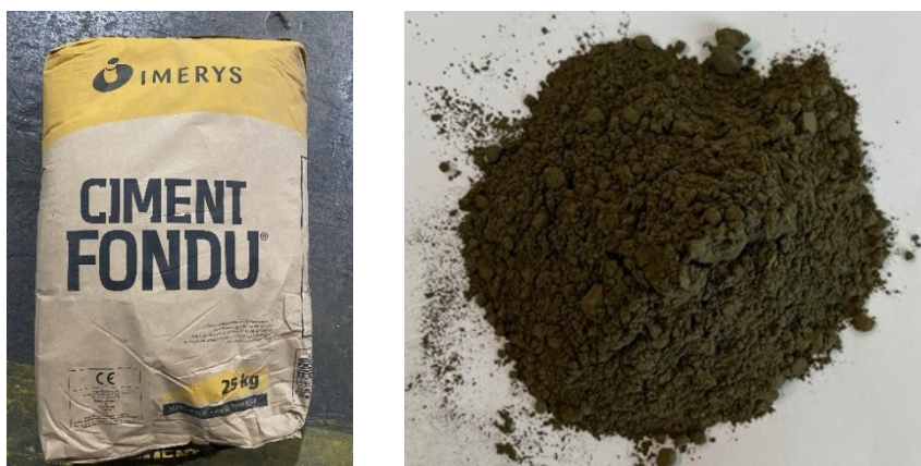
Fig. 9 - Polvere di cemento alluminoso usato per ridurre i fenomeni di efflorescenza.
