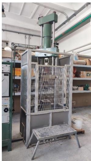
Fig. 40– Macchina di compressione Galbadini usata nella sperimentazione a sinistra; Setup di prova a flessione a destra prima e dopo la rottura
