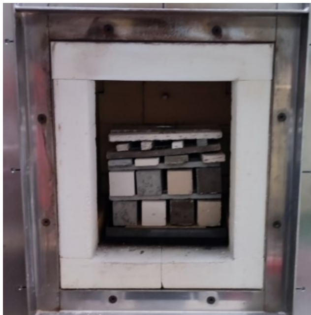
Fig. 36 – Disposizione dei provini in forno per la cottura a 200°C (medesima disposizione per le cotture a 400°C e 600°C).
