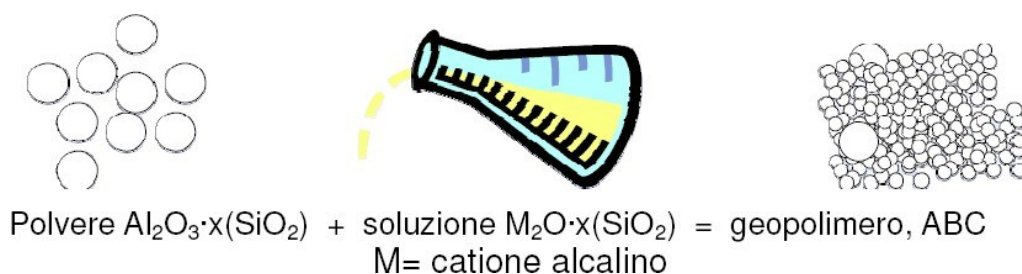
Fig. 9- Materie prime nella produzione del materiale geopolimerico.
