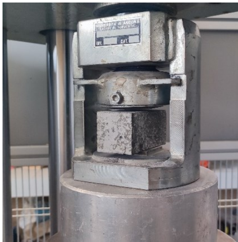
Fig.41 – Setup di prova a compressione.
