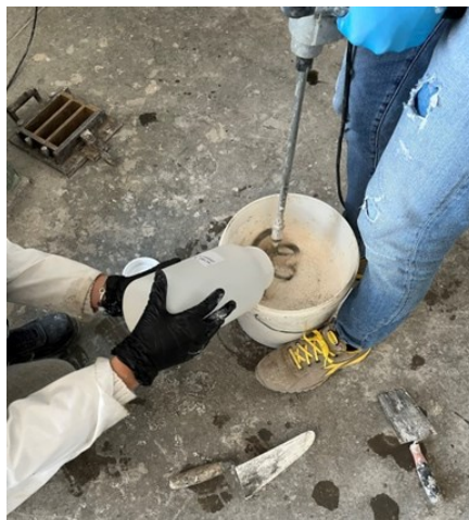
Fig. 20 – Miscelatore elettrico usato nella sperimentazione.
