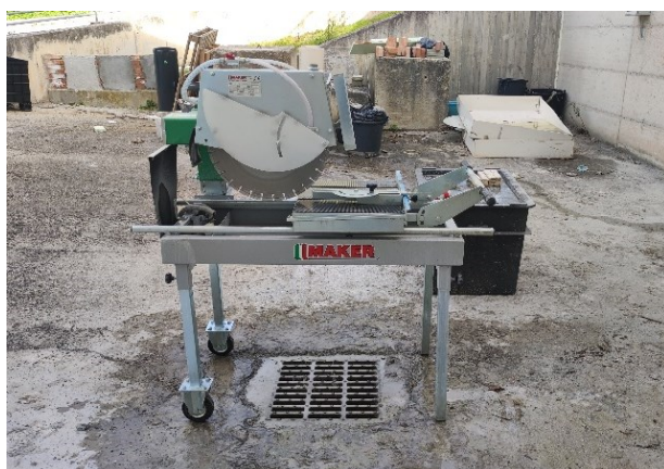
Fig. 31– Sega circolare per il taglio dei provini 38 \times 6 \times 1 \text{ cm}^3 .
