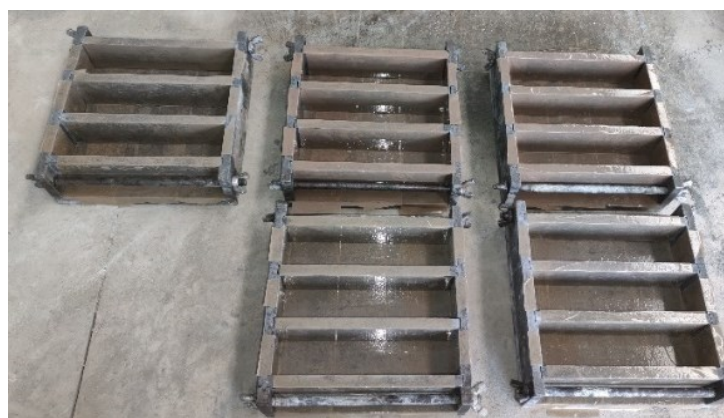
Fig. 13 – Casseri in metallo 16 \times 4 \times 4 \text{ cm}^3 con scotch per provini di malta geopolimerica.
