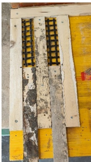
Fig. 15 – Casseri in legno 19 \times 4 \times 1 \text{ cm}^3 per malta commerciale a sinistra, per malta geopolimerica a destra.
