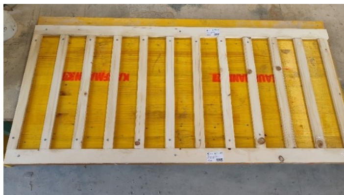
Fig. 19– Casseri in legno 38 x 6 x 1 cm 3 con scotch per provini in composito con malta geopolimerica
