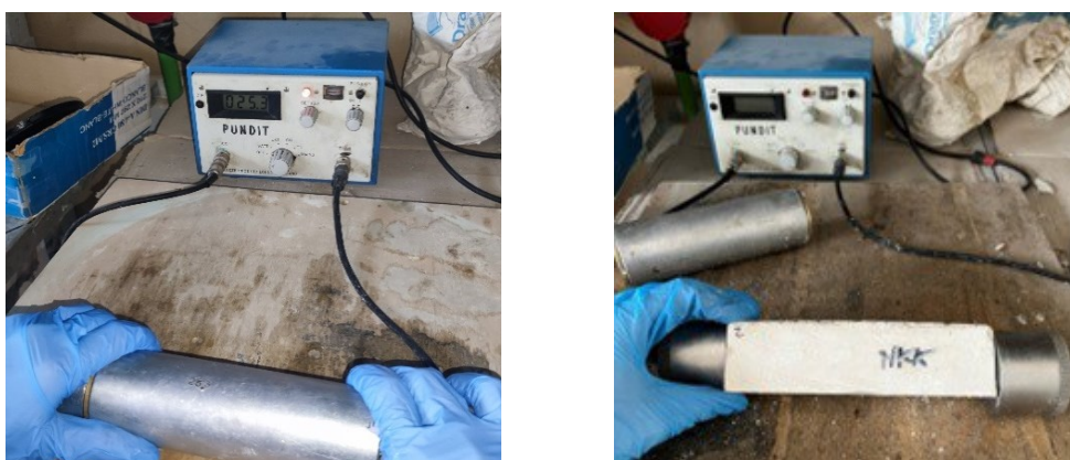
Fig. 39– Calibrazione dello strumento e misura delle onde ultrasoniche su un provino 16 \times 4 \times 4 \text{ cm}^3 .
