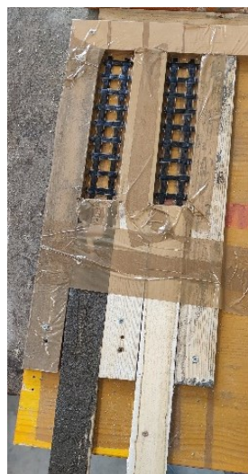
Fig. 15 – Casseri in legno 19 \times 4 \times 1 \text{ cm}^3 per malta commerciale a sinistra, per malta geopolimerica a destra.
