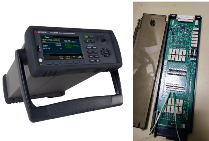
Fig. 37– Registratore di dati a sinistra; Esempio di collegamento di due termocoppie a destra.
