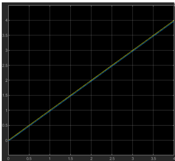
Figura 30 e figura 31: Risposta a un ingresso a rampa unitaria del sistema simulato a sinistra e errore tra ingresso e uscita a destra.
