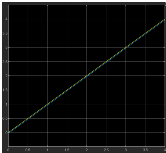
Figura 37 e figura 38: Risposta a un ingresso a rampa unitaria del sistema simulato a sinistra e errore tra ingresso e uscita a destra.
