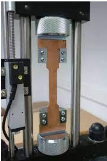
La prova a trazione è una prova di caratterizzazione meccanica del materiale, che in figura è ritagliato nella caratteristica forma a "osso di cane" e posizionato fra 2 morse. La prova consiste nello stiro del materiale fino a rottura o snervamento per analizzare il comportamento e i valori della forza in cui avvengono questi 2 eventi. È utile ricordare la legge di Hook:  $\sigma = E\varepsilon$ .
