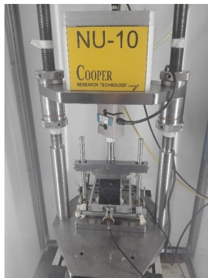
Figura 4.18 – Provino disposto all'interno del NAT e pronto per la prova
