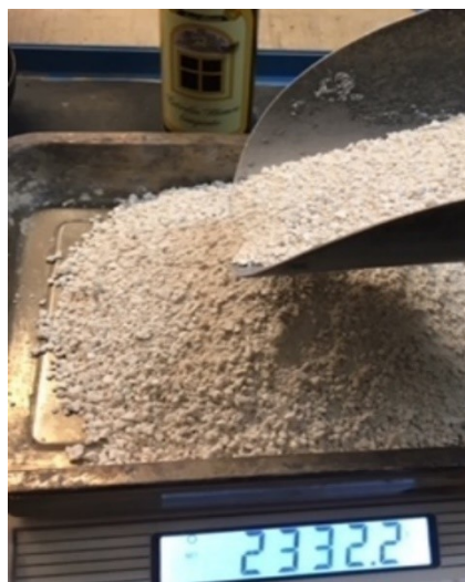
Figura 4.2 - Pesatura degli aggregati
