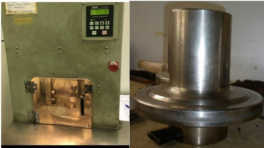
Figura 4.10 – Pressa giratoria e la sua fustella
