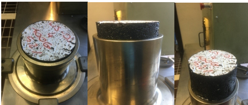
Figura 4.13 - Estrazione provini dalla fustella
