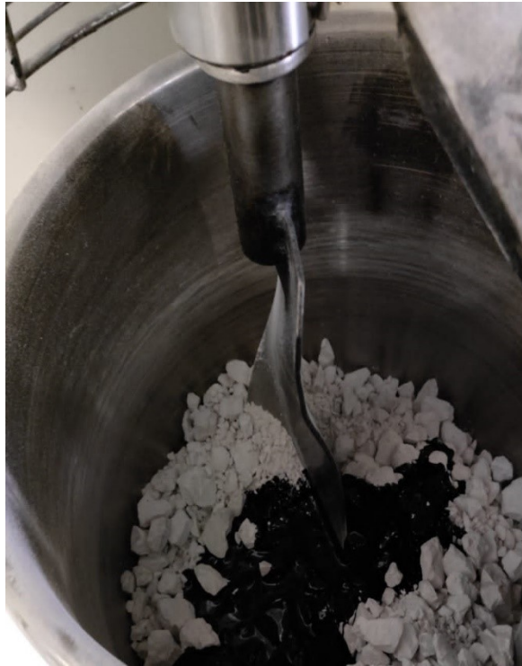
Figura 4.6 – Aggiunta del legante fluido della vasca di miscelazione
