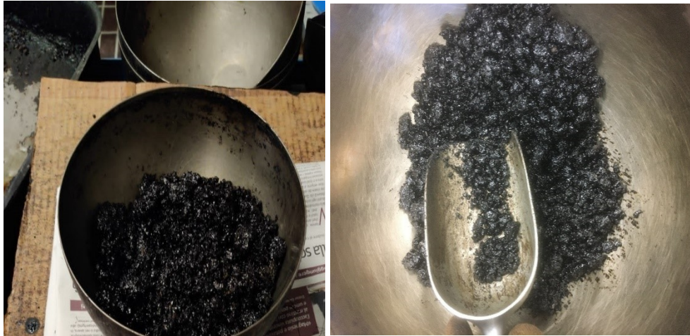
Figura 4.9 – Conglomerato preparato delle teglie, prima della compattazione
