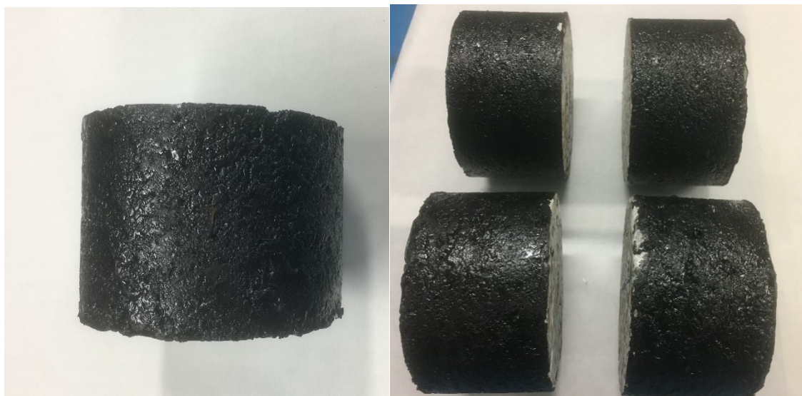
Figura 4.14 - Provini ottenuti alla fine della compattazione
