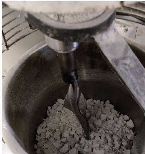
Figura 4.5 – Aggregati nella vasca di miscelazione
