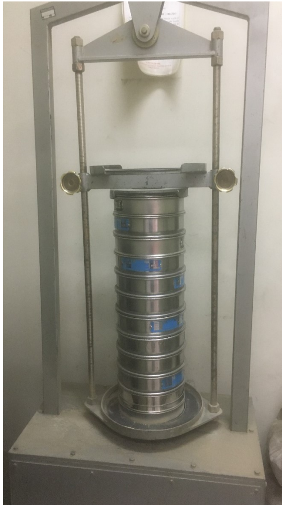
Figura 3.3 – Batteria setacci nel vibrovaglio
