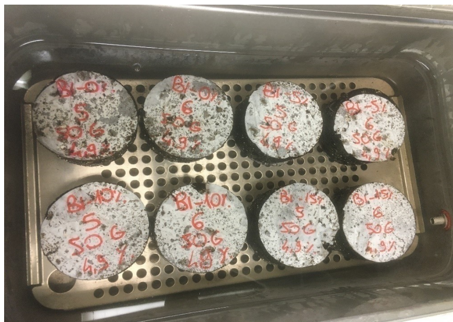
Figura 4.25 – Serie di provini durante il condizionamento in acqua
