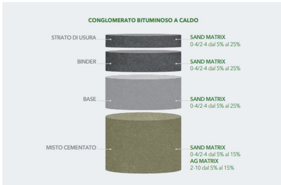
Figura 3.29 – Utilizzo di Matrix nei vari strati della pavimentazione
