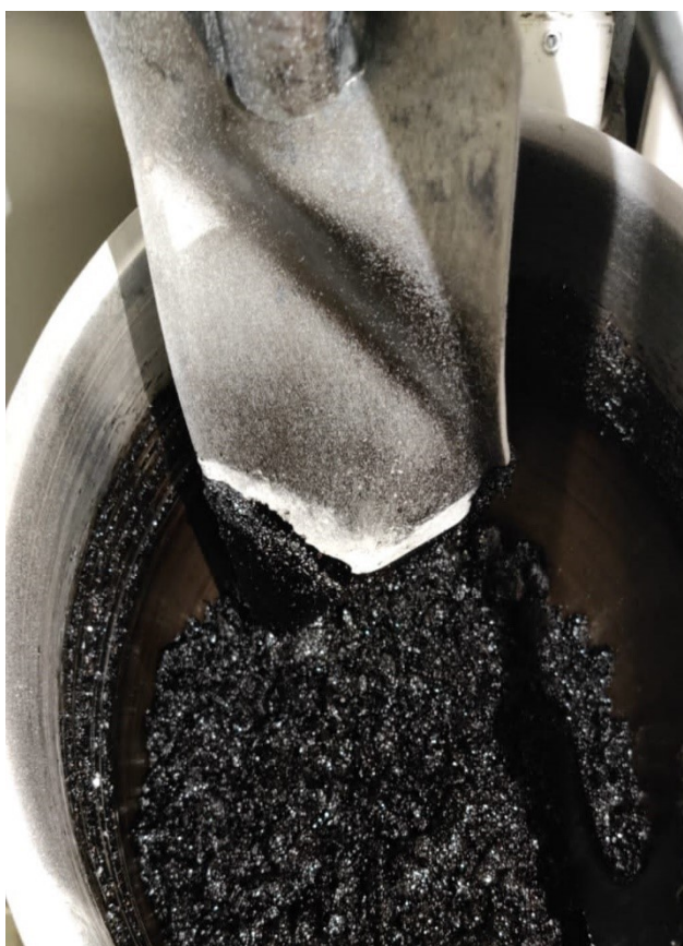
Figura 4.8 - Conglomerato al termine della miscelazione
